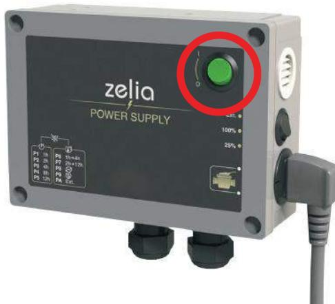
Falls ein Kontakt für die automatische Abdeckung an das Netzteil angeschlossen ist, muss der Schalter an der Seite des Netzteils auf EXT stehen, um diese erfassen zu können. Es ist weiterhin möglich, den Schalter auf 100 % zu stellen, um über die Angabe der Abdeckung des Beckens hinauszugehen und die nominale Produktion zu erzwingen, bzw. den Schalter auf 25 % zu stellen, um die Produktion ohne Berücksichtigung des Zustands der Abdeckung auf ein Viertel zu senken.
