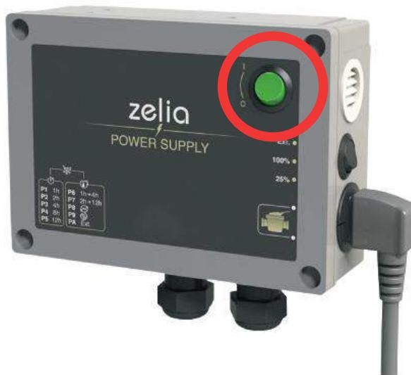
Jeśli styk bezpotencjałowy przykrycia automatycznego jest podłączony do skrzynki, przełącznik znajdujący się z boku skrzynki powinien być w pozycji EXT, aby umożliwić wykrycie. Możliwe jest przełączyć przełącznik na 100%, by zignorować informację o przykryciu i wymusić nominalną produkcję lub na 25%, aby podzielić produkcję na 4 etapy niezależne od statusu przykrycia.
